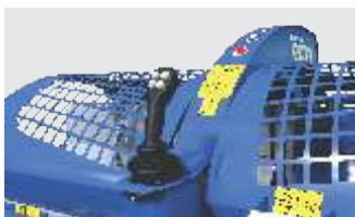
»Joystick« - maniement simple et ergonomique. Toutes les fonctions élémentaires de la machine (alimentation droite/gauche, coupage, fendage et avancement des couteaux de fendage) se fait par une simple manette.
