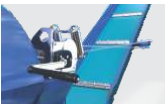
Treuil manuel d'inclinaison du tapis d'évacuation.
